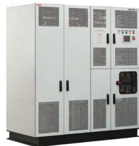
Характеристики: • базовая система 500 кВт; • Инвертор И + Шкаф управления ШУ; • степень защиты: IP21; • габариты: 2.0 x 2.2 x 1.0 [м] (WxHxD); • масса: 2100 кг; • охлаждение: принудительное воздушное.
