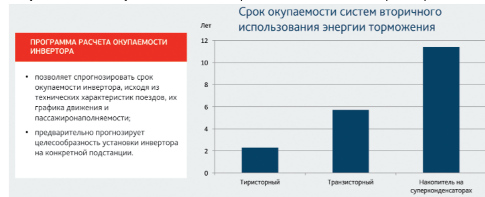
Рисунок 12. Расчёт окупаемости систем вторичного использования энергии торможения
