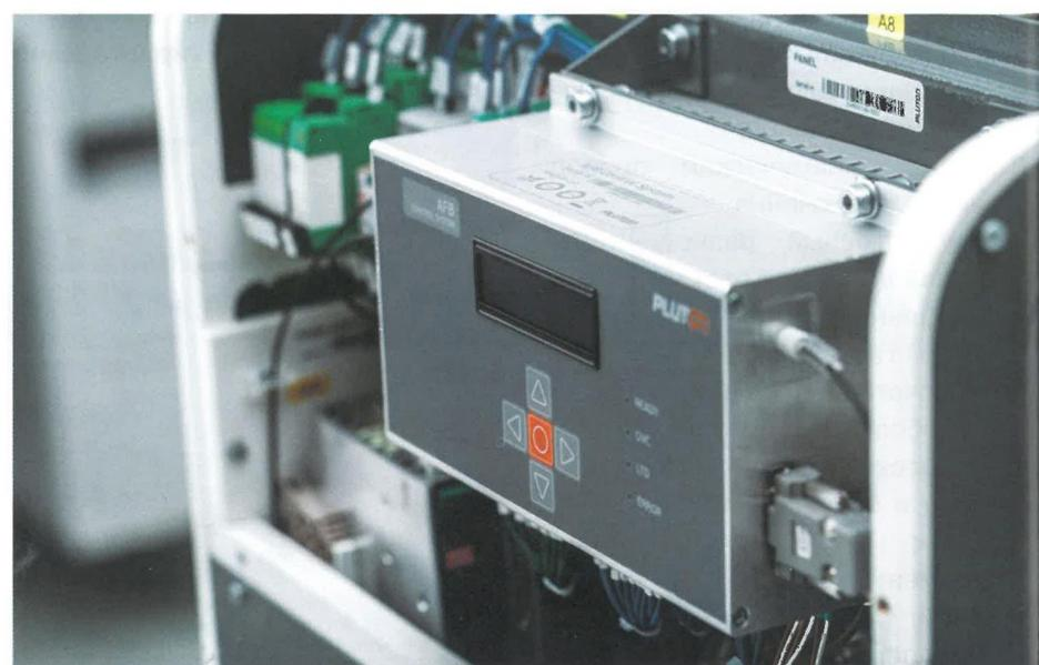
Рис. 8 Процессорный модуль системы управления и внутреннего мониторинга выключателя AFB
